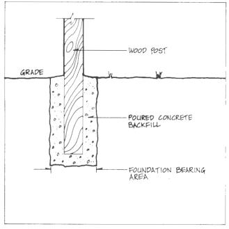
Figure 4.10. Concrete Backfill
