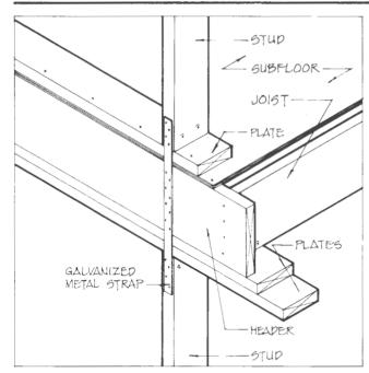
Figure 4.44. Stud-to-Stud Connections
